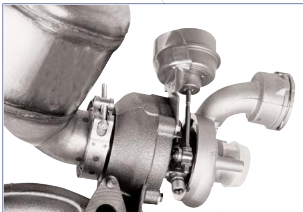
Automobil: Spojení turbodmychadlo - katalyzátor
